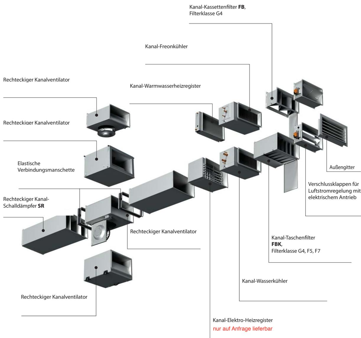
Bild: Prinzipschema / Beispiel einer Zu- oder Abuftventilation mit Wärmerückgewinnung
