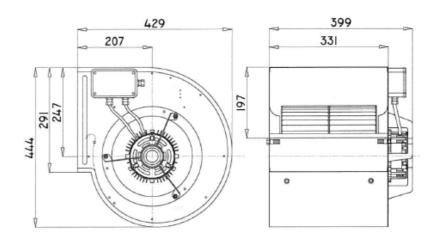
Ausführung: DA Radialventilator mit Radialgehäuse und Ventilatorlaufrad aus verzinkten Stahlblech gefertigt - mit 1Ph Drehstrommotor direkt angebaut - Schutzklasse IP 20-30 und Luftleistung bis ca. 3'600 m3/h
